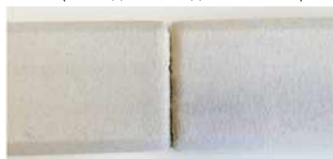
Фабричный стык (так изделие сходит со станка)
