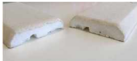
Фабричный стык (так изделие сходит со станка)
